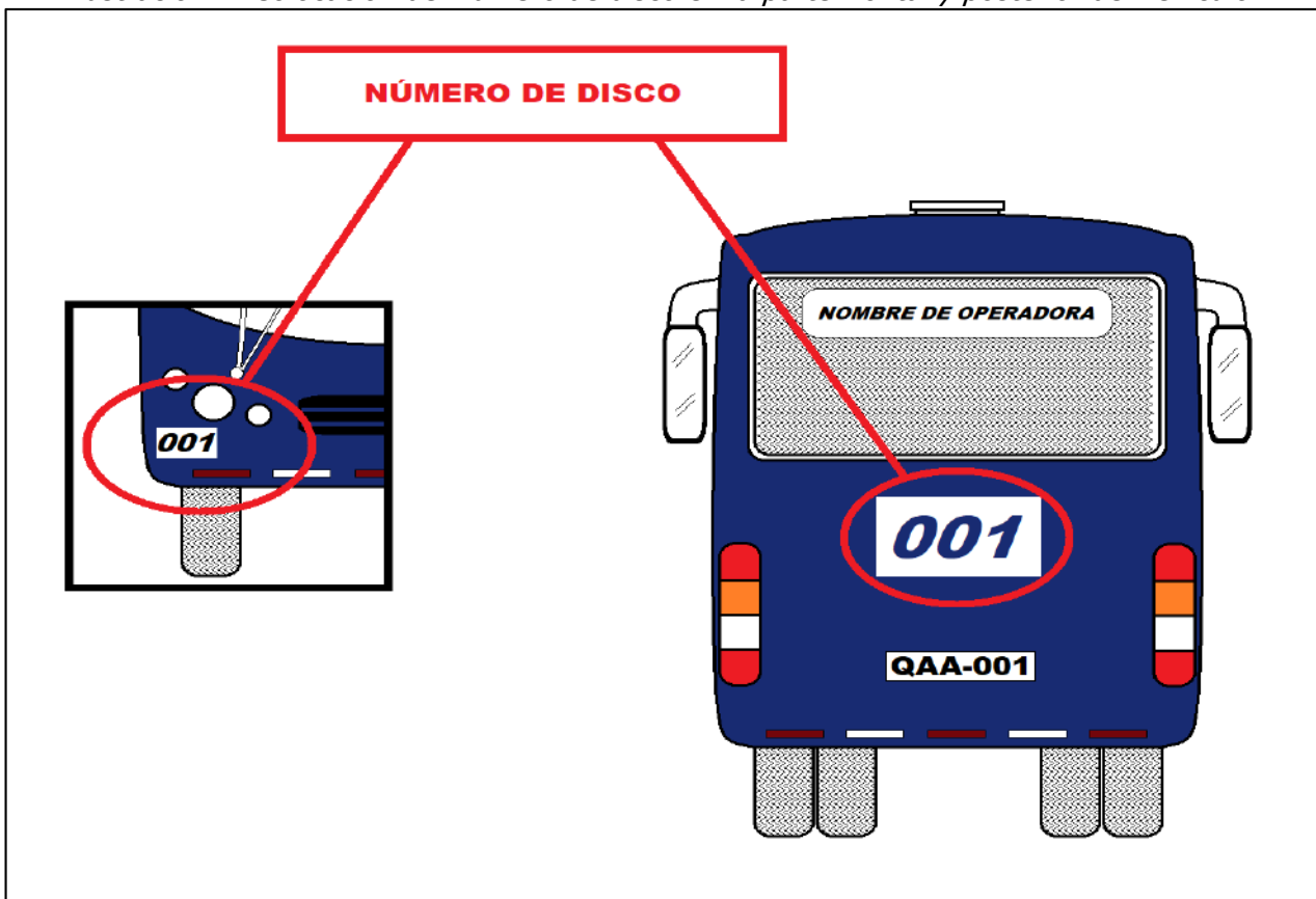
Ilustración 4: Colocación del número de disco en la parte frontal y posterior del vehículo.
